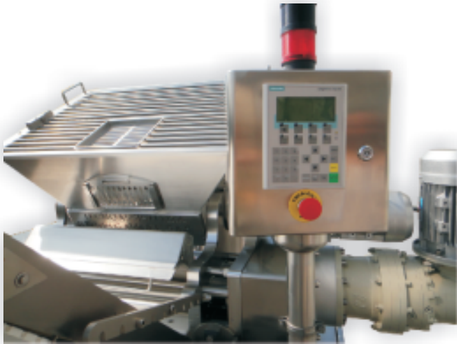
Pannello di controllo PLC
